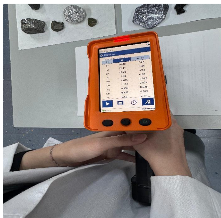
Сурет 11 – XRF құрылғы экранындағы элементтік құрам нәтижесі
