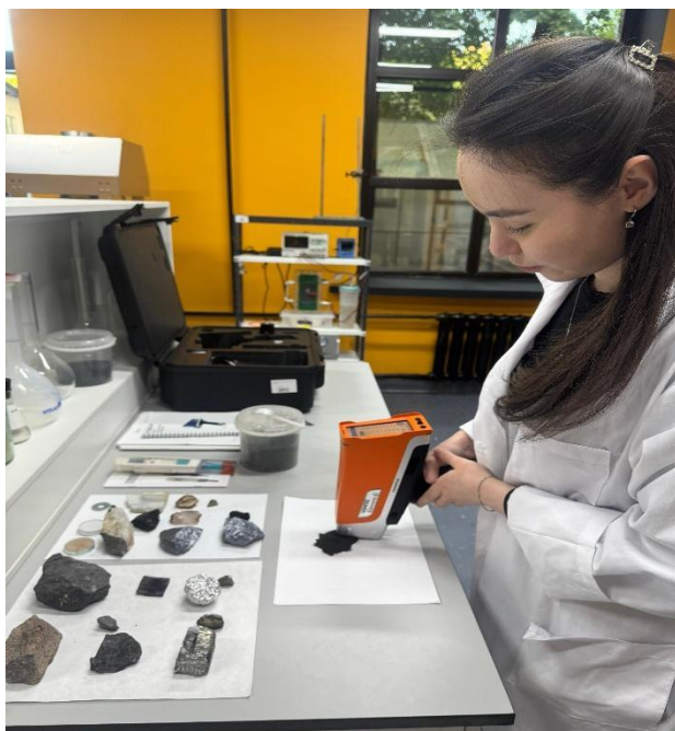
Сурет 10 – Olympus Vanta Element-S құрылғысымен жапырақ күлін талдау процесі
